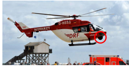
Abb. 9: Größe des Radarmoduls an BK 117
